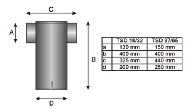
TSD130 - 18/32 Abgasschalldämpfer für EUROLINE E18 - E32 und Ratioline R
